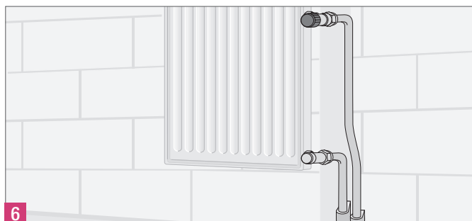
Рис. 11-12 Подключение к запорно-регулировочной арматуре радиатора с помощью переходника с наружной резьбой RAUTITAN MX
